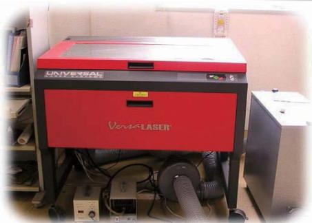
ものづくりに使用できる機械を多数設置しています。この写真は「レーザー彫刻機」です。この装置を使ってネームプレートを作るデモをお見せします。
